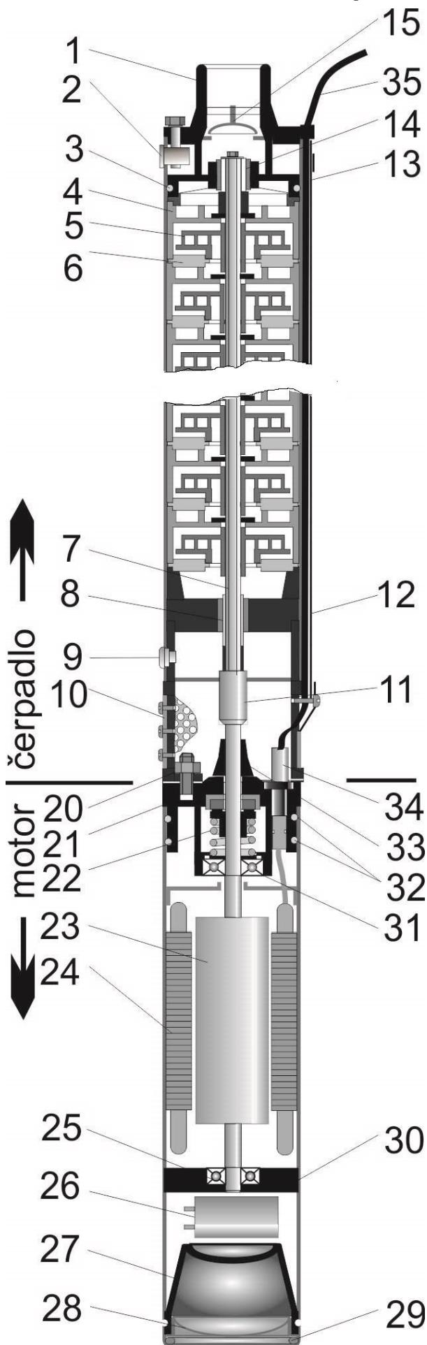
1. ložisková podpěra horní s výstupním hrdlem 1,5"
