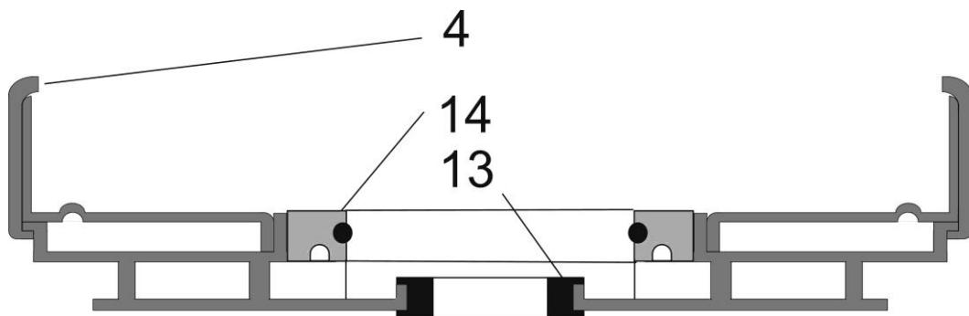
Díly 13 a 14 jsou vyjímatelné a lze je samostatně vyměnit
